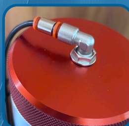
Entrée d'air comprimé
